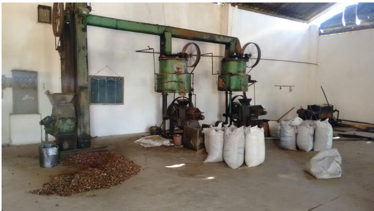
Figura 2: Máquina de processamento da amêndoa para obtenção do óleo de babaçu – Sede da COPPALJ
