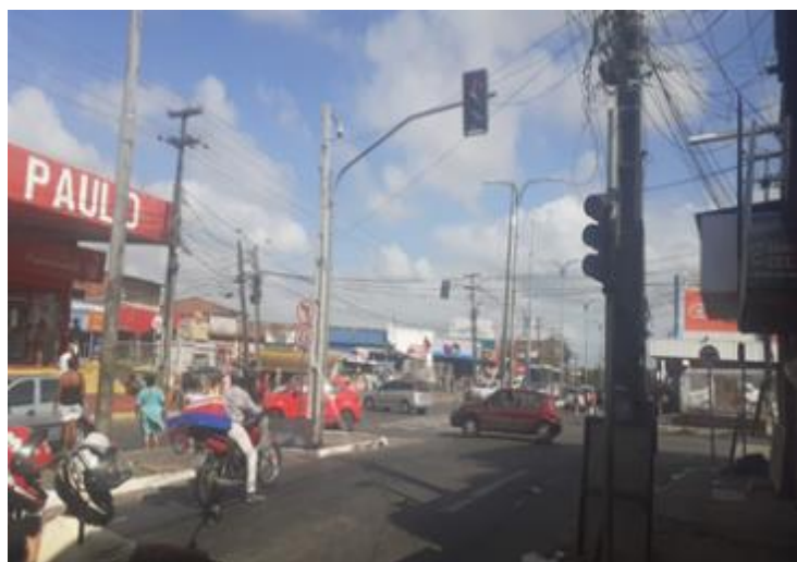
Foto 13 – Semáforo para pedestres sem botão de acionamento e sem sinal sonoro na Avenida São Marçal
