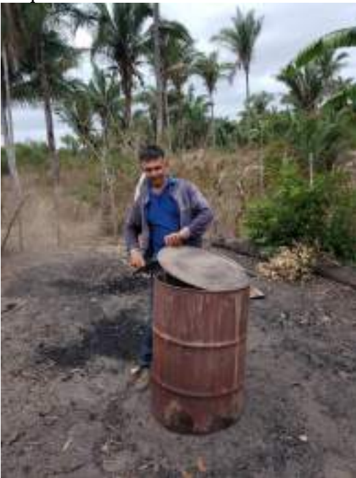
Imagem 26 – queima da casca do coco babaçu para produção do carvão na imagem a esquerda e a direita o seu uso.
