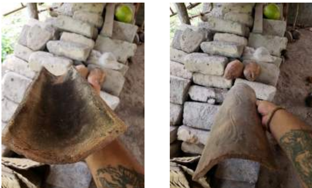
Imagem 06 – Telha de coxa 24 preservada de uma antiga cobertura
