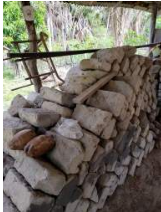
Imagem 05 – Forma de adobo e tijolos de adobe armazenados no alpendre
